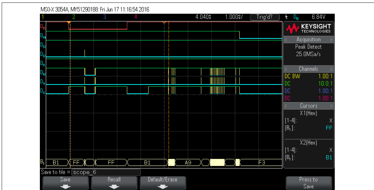
Figure 11: Logikanalysator Screenshot Datenübertragung GPIB Signale
